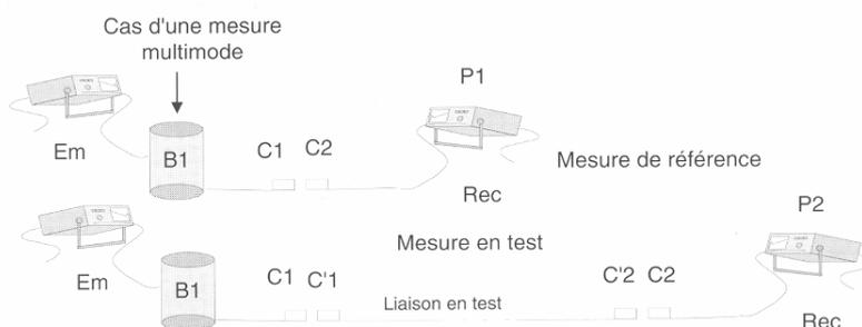
L'opérateur procède à une première mesure de perte P1 en raccordant C1 et C2. Il insère ensuite la liaison en test et procède à la mesure P2. Les pertes en dB de la liaison en test sont égales à  $ex = 10 \log (P1/P2)$ . Dans la pratique les récepteurs permettent d'effectuer directement ce calcul.
