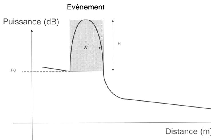
**Réfectomètre optique OTDR**
